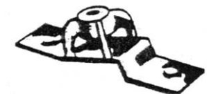
۷- پایه مخصوص نصب روی پشت‌بام‌های شیبدار
